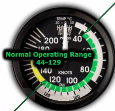
Il limite inferiore è la velocità di stallo con carrello e flaps retratti al C.G. più avanzato  $V_s$ .
