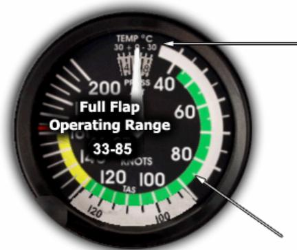
Il limite inferiore è la velocità di stallo al peso massimo in configurazione di atterraggio con flaps carrello completamente estesi  $V_{so}$ .
