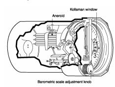
L'altimetro è costituito da una cassa a tenuta stagna, che è collegata con l'esterno attraverso la cosiddetta "presa statica", al cui interno si trova la capsula, ermeticamente chiusa.
